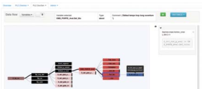
Ansicht Kontrollfluss im PLC DocGen
